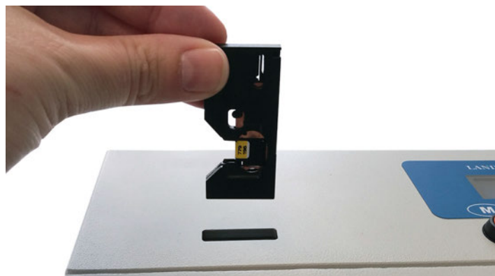
| Positionnement d'un nanoDot dans son adaptateur
