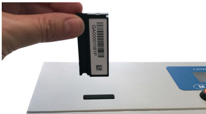
| Positionnement d'un dosimètre InLight GA
