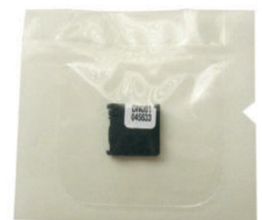
nanoDot dans son conditionnement scellé
